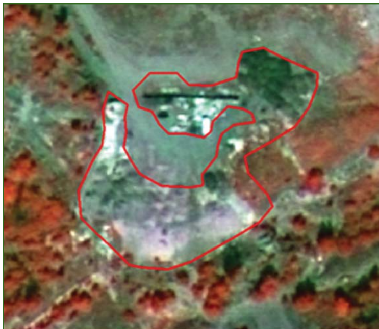
Рис. 2 Строительная свалка площадью 0,41 га (снимок с КА «Ресурс-П», разрешение 0,75 м)
